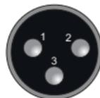
Verbinde an 1 Seite PIN 1 mit PIN 3 für ein unbalanciertes XLR Kabel..
