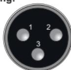
**Verbind aan 1 zijde PIN 1 met PIN 3 voor ongebalanceerde XLR verbinding.**
