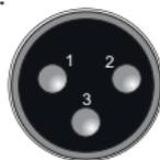
**Raccordez d'un côté PIN 1 avec PIN 3 pour raccord XLR non-équilibré.**
