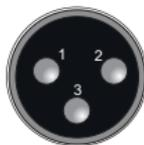
Verbinde an 1 Seite PIN 1 mit PIN 3 für unbalancierte XLR Verbindung.
