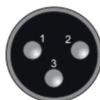
**Raccordez d'un côté PIN 1 avec PIN 3 pour câble XLR non-équilibré.**
