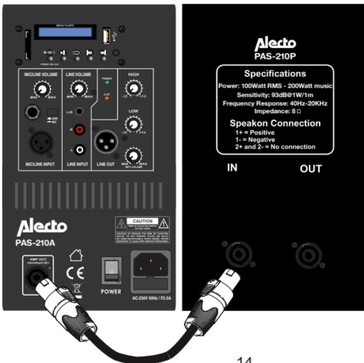
Le PAS-210P réceptionne son signal du PAS-210A ou d'un autre amplificateur qui est raccordé via le câble de l'haut-parleur avec des fiches Speakon livré avec.
